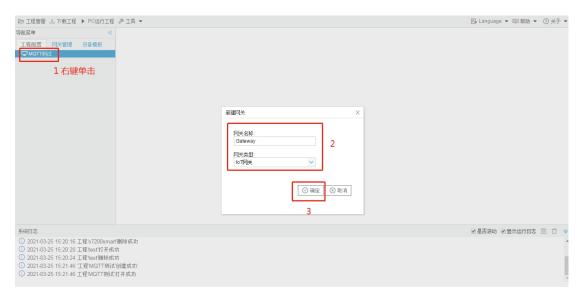
3. 配置通道 , 右键 "I/0 点" , 选择 "新建通道" -----通道选择 "串口" -----驱动名称 选择 "ModbusRTUClient" ; 选择协议 创建设备 串口号: 选择 与采集设备连接的 串口号; 波特率,数据位,停止位,奇偶校验这个参数根据采集设备 进行配置 , 但通用的设置 成 9600 -- 8 --1 - -N 即可;
