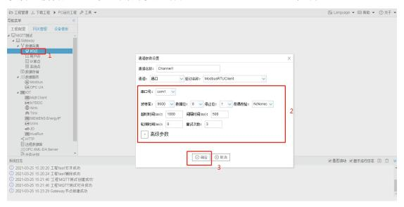
4. 新建设备 , 右键"Channel1"---"新建设备"---填入"设备名称": Device1---输入 "设备地址" ---点击"确定"
