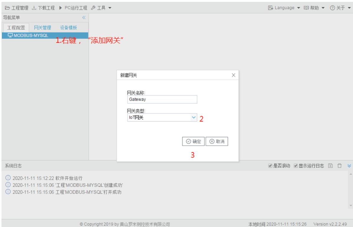
3.配置通道，右键“I/O点”，选择“新建通道”---通道选择“串口”---驱动名称 选择“ModbusRTUClient”；选择协议 创建设备 串口号：选择 与采集设备连接的 串口号；波特率，数据位，停止位，奇偶校验这个参数根据采集设备 进行配置，但通用的设置成 9600 -- 8 --1 --N即可；
